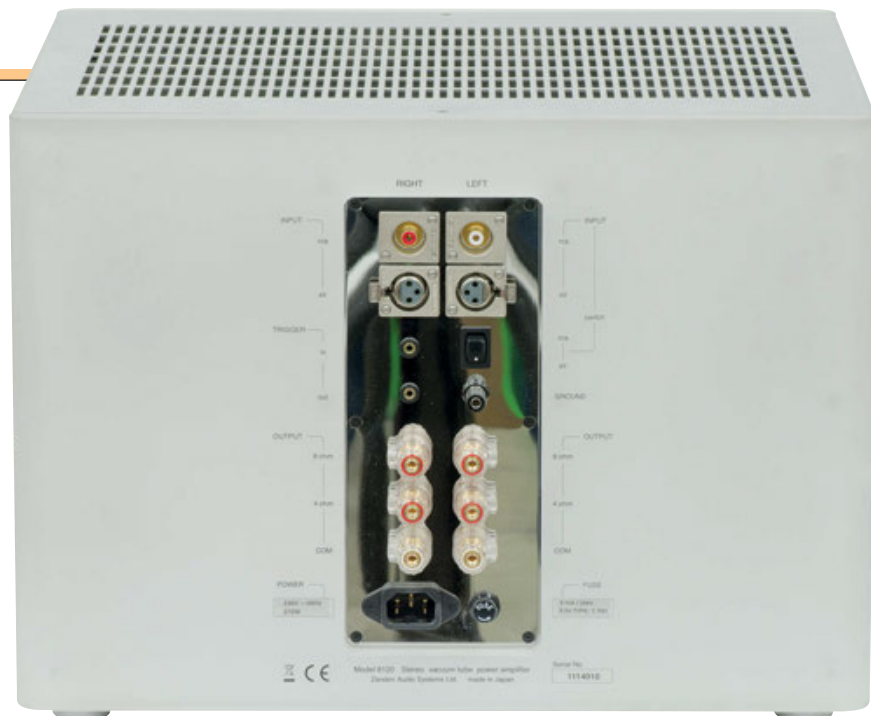
I WBT di uscita sono sdoppiati, per impedenze nominali di 8 e 4 ohm, ma dai test al banco risulta che la massima versatilità si ottiene con l'uscita da 4 ohm.
