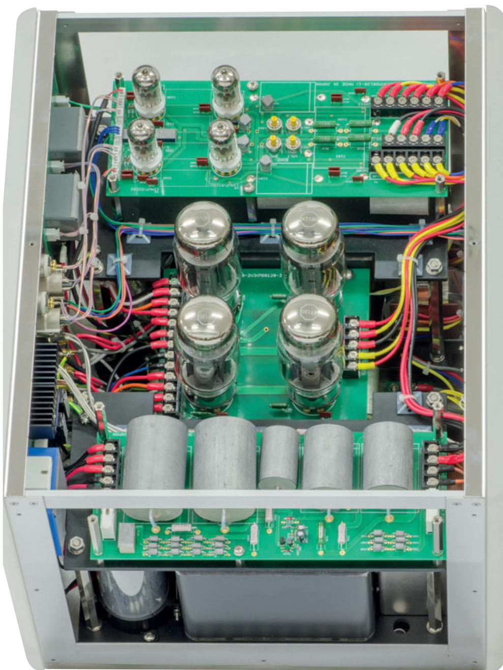
Alcune delle peculiarità progettuali del finale Model 8120 sono visibili già al colpo d'occhio dell'interno, come l'impiego di trasformatori di segnale per ottenere l'ingresso bilanciato e l'assenza di elettrolitici non solo sul segnale, ma anche nell'alimentazione degli stadi di amplificazione. Come nel pre, tutti i componenti che non dissipano calore sono rivestiti con una tela adesiva, con probabile funzione principale di smorzamento meccanico.
