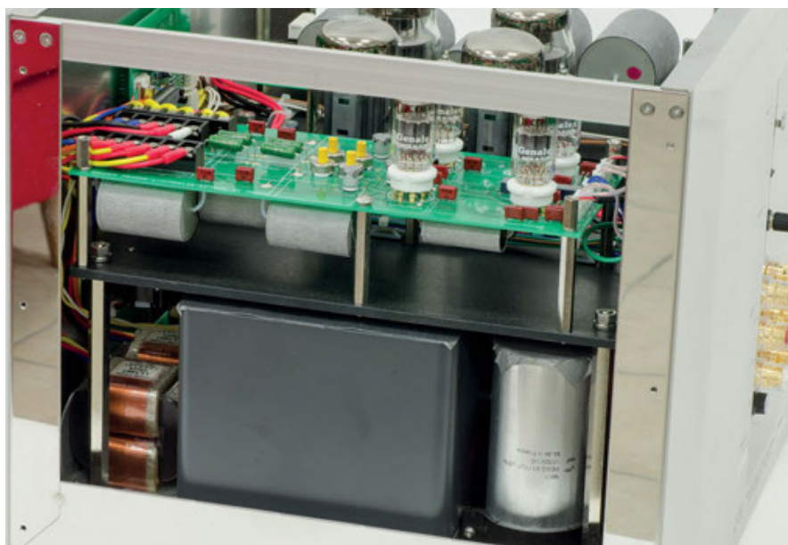
Particolare dei trasformatori di ingresso del finale e delle connessioni filari con guaina in teflon, utilizzate anche nel pre.
